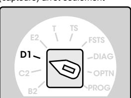
Réglage optionnel: C2 Contact momentané pour ouvrir, pression constante pour fermer, LMEP (capteurs) pour inverser
