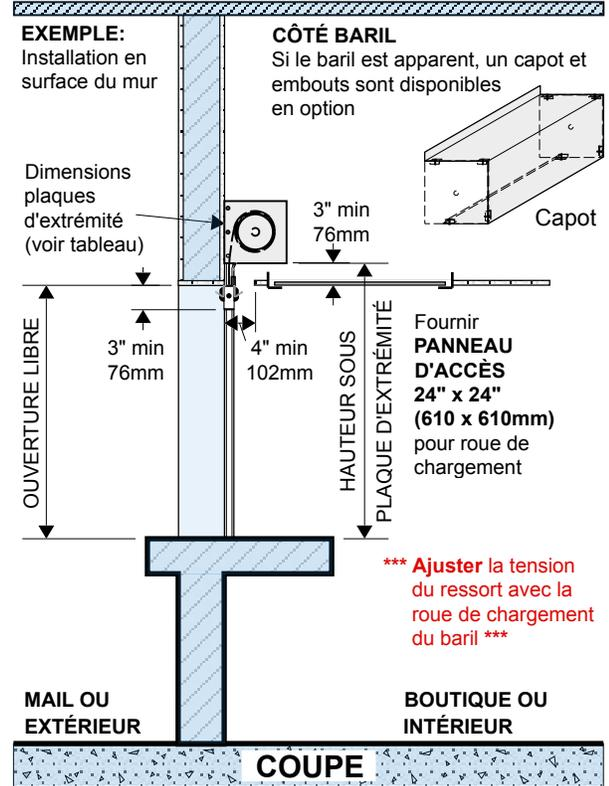
\*\*\* Ajuster la tension du ressort avec la roue de chargement du baril \*\*\*
