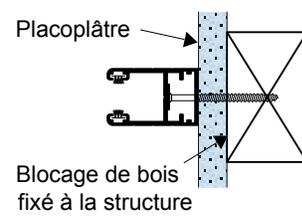
Pour plaques d'extrémité 10" x 10" (254 x 254mm) et Moteur tubulaire:
